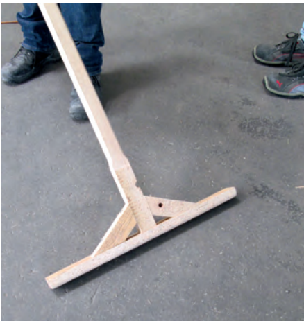
Abb. 3: Schieber zum Zusammenschieben größeren Schmutzes in einer Lehrlingswerkstatt für Dachdecker (Foto: Gunreben)
