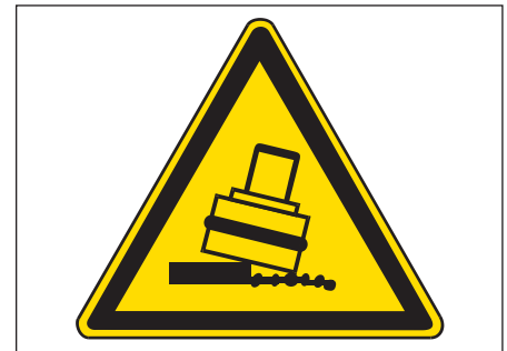
Abb. 2: Symbol Anschnallen! und Abb. 3: Warnzeichen Kippgefahr – Diese Sicherheitszeichen sind in den Fahrerkabinen von Walzen anzubringen – sie können über das Medien-Center der BG BAU bestellt werden
