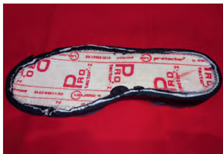
Abb. 2: Querschnitt durch einen Sicherheitsschuh mit perforationsbeständiger Einlage aus Metall (Quelle: IFA, Sankt Augustin)
