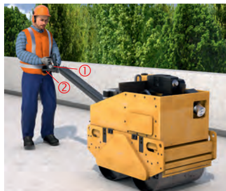
Abb. 1: Walze mit „Totmannschaltung“ (1) (Schalteinrichtung ohne Selbsthaltung) und „Andrückschalter“ (2)
