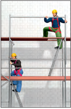
Abb. 6, 7 und 8: Ablauf der Gerüstmontage unter Verwendung des MSGs und PSaGA
