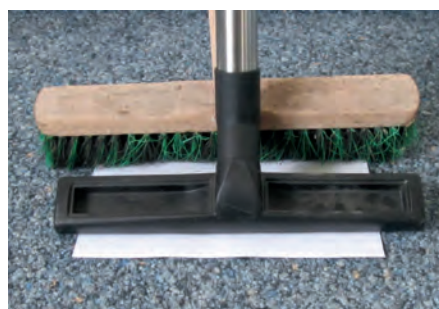
Abb. 4c: Bodendüse mit 360 mm Breite vor einem Straßenbesen mit 400 mm Breite (Foto: Gunreben)
