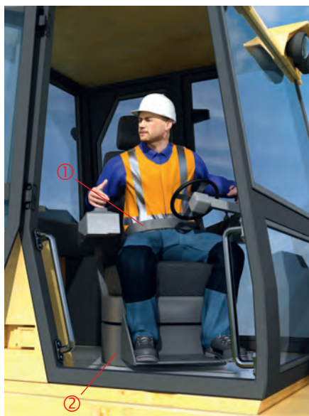
Abb. 4: Beim Betrieb von Walzen mit Überrollschutzkonstruktion (ROPS) Sicherheitsgurt (1) anlegen. Drehsitze (2) bei Walzen ermöglichen auch bei Rückwärtsfahrt den Blick in Fahrtrichtung. Sie ersparen unbequemes und trotzdem nicht immer ausreichendes Umdrehen des Maschinenführers. Damit können tote Winkel deutlich reduziert werden sowie die Arbeit des Maschinenführers erleichtert und ergonomischer gestaltet werden.
